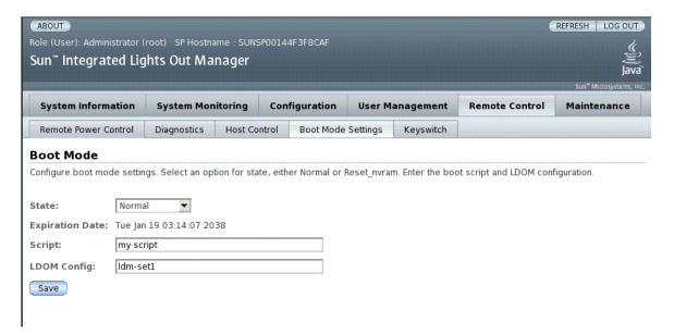
ILOM ofrece varios métodos para configurar el entorno del firmware del servidor. Existen cuatro aspectos para configurar el modo de inicio:
