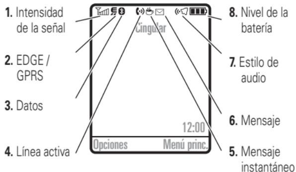
**1 Indicador de intensidad de la señal:** Las barras verticales indican la intensidad de la conexión de red. No podrá realizar ni recibir llamadas cuando aparezca o .
