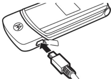
Luego, enchufe el cargador de batería al teléfono y a una toma de corriente. El teléfono puede tardar varios segundos antes de comenzar a cargar la batería. Al finalizar la carga, en la pantalla aparece **Carga completa**.
