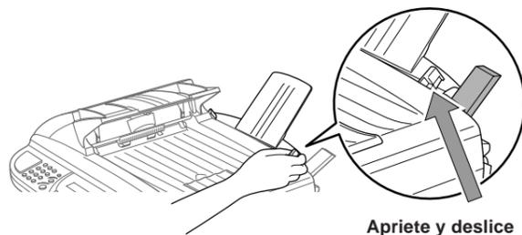
**C.** Apriete hacia abajo la palanca del papel. Cargue el papel (con la palanca hacia abajo). Asegúrese de que el lado de impresión quede hacia el aparato de fax y que la palanca del papel quede por debajo de la marca del papel. El alimentador tiene capacidad para 200 hojas, o 10 sobres.
