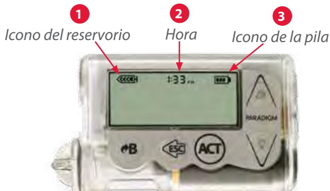
PANTALLA INICIO CON ICONOS Y HORA Cuando aparece la pantalla INICIO, la bomba está encendida y lista para programarse.
