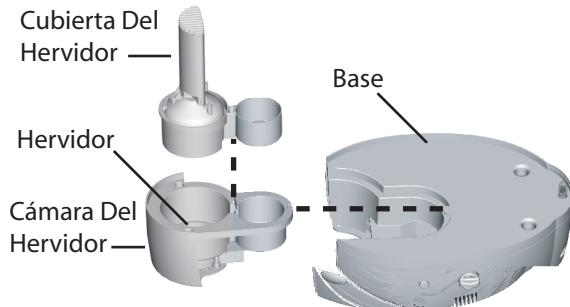
4. Coloque la cámara del hervidor en un fregadero vacío y cuidadosamente levante la cubierta de la cámara presionando su lengüeta de liberación. Esto dejará el calentador al descubierto. Drene toda al agua y enjuague con agua fresca y limpia. Use una escobilla suave o una esponja para limpiar la cámara del hervidor y su cubierta.
