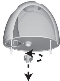
5. Reinstale la tapa del tanque enroscándola en sentido horario al tanque de agua.
