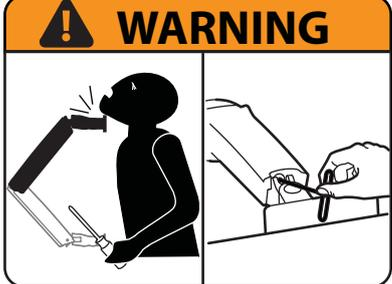
**ADVERTENCIA:** Riesgo de energía almacenada: El mecanismo del brazo está bajo tensión y se moverá rápidamente hacia arriba, por sí mismo, tan pronto como se retire el equipo acoplado. Por ello, NO retire el equipo a menos que esté colocado en su posición más elevada. El incumplimiento de esta instrucción puede provocar lesiones personales graves y dañar el equipo.
