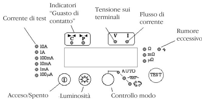
Premete l'interruttore On/Off per accendere il DLRO 10. Si accenderanno tutte le spie luminose, le spie V e I lampeggeranno, sarà mostrata la versione del software e la spia W si illuminerà. Se i cavi del test non sono stati collegati al campione del test si accenderanno anche le spie luminose 'C' e 'P'. Premete di nuovo il pulsante On/Off per spegnere lo strumento. Se lo strumento non viene usato per 5 minuti si spegnerà automaticamente.
