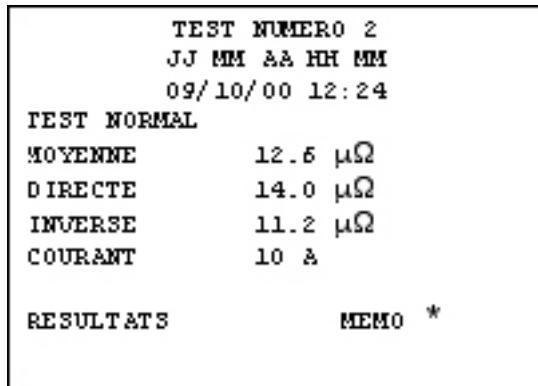
Utiliser les commandes Monter et Descendre du curseur pour passer respectivement au résultat enregistré plus récent ou plus ancien. Autrement, si vous savez le numéro d'indice du test que vous voulez afficher, tapez le numéro sur le clavier et appuyez sur Enter.
