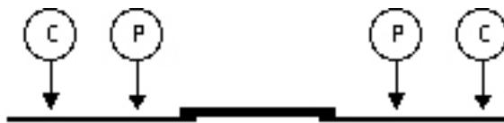
Bei Verwendung von Doppelsonden schienen sicherstellen, dass sich die mit P gekennzeichnete Sonde innenseitig von der mit C gekennzeichneten befindet.
