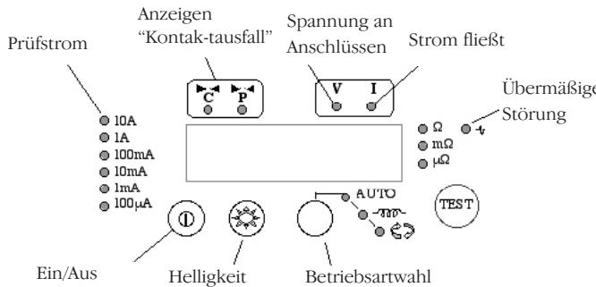
Ein-/Aus-Schalter zum Einschalten des DLRO 10 drücken. Alle Leuchten leuchten auf, die Leuchten 'V' und 'T' blinken, die Softwareversion wird angezeigt und die Leuchte 'W' leuchtet auf. Wurden die Prüfkabel noch nicht am Prüfobjekt angeschlossen, dann leuchten auch die Leuchten 'C' und 'P' auf. Ein-/Aus-Schalter erneut drücken, um das Gerät auszuschalten. Wird das Gerät 5 Minuten lang nicht benutzt, schaltet es sich automatisch aus.
