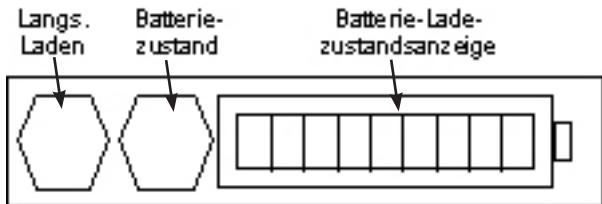
Auf der Vorderseite des Batteriemoduls befinden sich zwei Tasten und eine LED-Anzeige mit 10 Segmenten.
