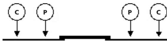
Si se utilizan barras dobles, asegúrese de que el cabezal medidor P está dentro de los cabezales C.
