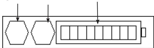
Para conocer la cantidad de carga en su módulo de batería, ya esté conectada a su DLRO o por separado, pulse el botón de estado de la batería. El indicador de estado de la batería encenderá entre 1 y 10 segmentos, lo que significa una carga del 10% y 100% respectivamente. Despues de unos segundos, la pantalla se apagará automáticamente.
