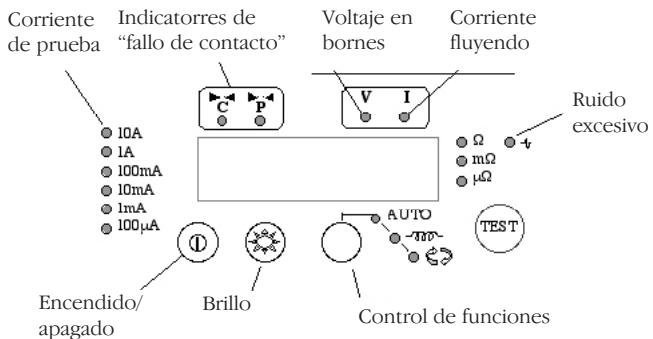
Pulse el interruptor de encendido/apagado para encender el DLRO 10. Todas las lámparas se encenderán, las lámparas V y I parpadearán, se mostrará la versión de software y se encenderá la lámpara  $\Omega$ . Si los cables de prueba no se han conectado a la muestra de prueba, las lámparas 'C' y 'P' también se encenderán. Pulse de nuevo el interruptor de encendido/apagado para apagar el instrumento. Si el instrumento no se utiliza durante 5 minutos, se apagará automáticamente.
