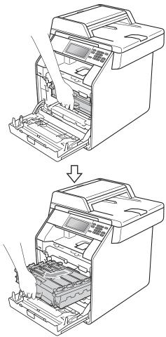
Gire la palanca de bloqueo verde (1) (situada en el lado izquierdo del equipo) en dirección contraria a las agujas del reloj hasta alcanzar la posición de liberación. Mientras sujeta las asas verdes de la unidad de tambor, levante la parte frontal de la unidad de tambor y retírela del equipo.
