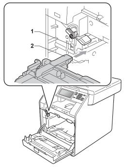
Gire la palanca de bloqueo verde (1) en la dirección de las agujas del reloj hasta la posición de bloqueo.
