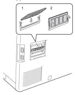
6 Vuelva a colocar la cubierta de metal (2) y, a continuación, la cubierta de plástico (1) del módulo SO-DIMM.
