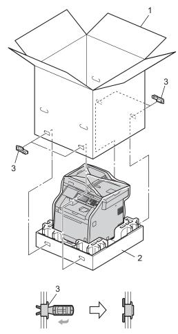
Coloque las dos piezas de espuma de poliestireno (1) dentro de la caja de cartón de modo que la parte derecha del equipo coincida con la marca "RIGHT" de una de las piezas de espuma de poliestireno y la parte izquierda del equipo con la marca "LEFT" de la otra pieza. Coloque el cable de alimentación CA y los materiales impresos en la caja de cartón original tal y como se muestra en la ilustración.
