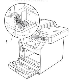
Haga coincidir los extremos de las guías (2) de la unidad de tambor con las marcas ► (1) que se encuentran a ambos lados del equipo y, a continuación, coloque la unidad de tambor dentro del equipo hasta que se detenga en la palanca de bloqueo verde que se encuentra en la posición de liberación.
