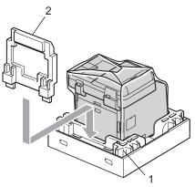
19 Coloque la caja de cartón más alta (1) sobre el equipo y la caja de cartón más baja (2). Alinee los orificios de unión de la caja de cartón más alta con los orificios de unión de la caja de cartón más baja.
