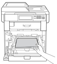
Asegúrese de que la palanca de bloqueo verde (1) se encuentra en la posición de liberación, tal como se muestra en la ilustración.
