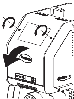
Apertura de la puerta del armario eléctrico
