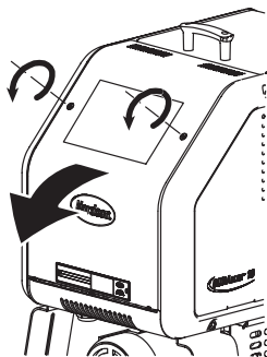
Apertura de la puerta del armario eléctrico
