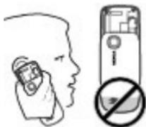
Es posible que su dispositivo tenga antenas internas y externas. No toque la antena cuando esté transmitiendo o recibiendo a menos que sea necesario. El contacto con antenas afecta a la calidad de la comunicación, puede originar una potencia superior durante el funcionamiento y puede acortar la duración de la batería.
