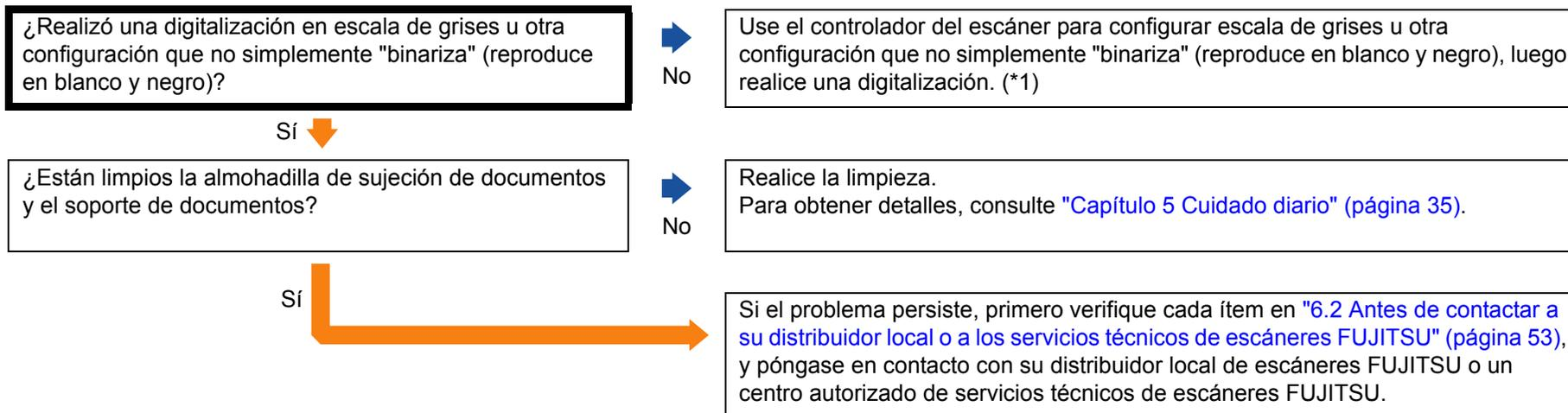
\*1: Es posible que la imagen digitalizada difiera significativamente de la original si simplemente "binariza" (reproduce en blanco y negro) una ilustración o una fotografía. Si es posible, use el controlador del escáner para configurar escala de grises u otra configuración que no simplemente "binariza" (reproduce en blanco y negro), luego realice una digitalización.
