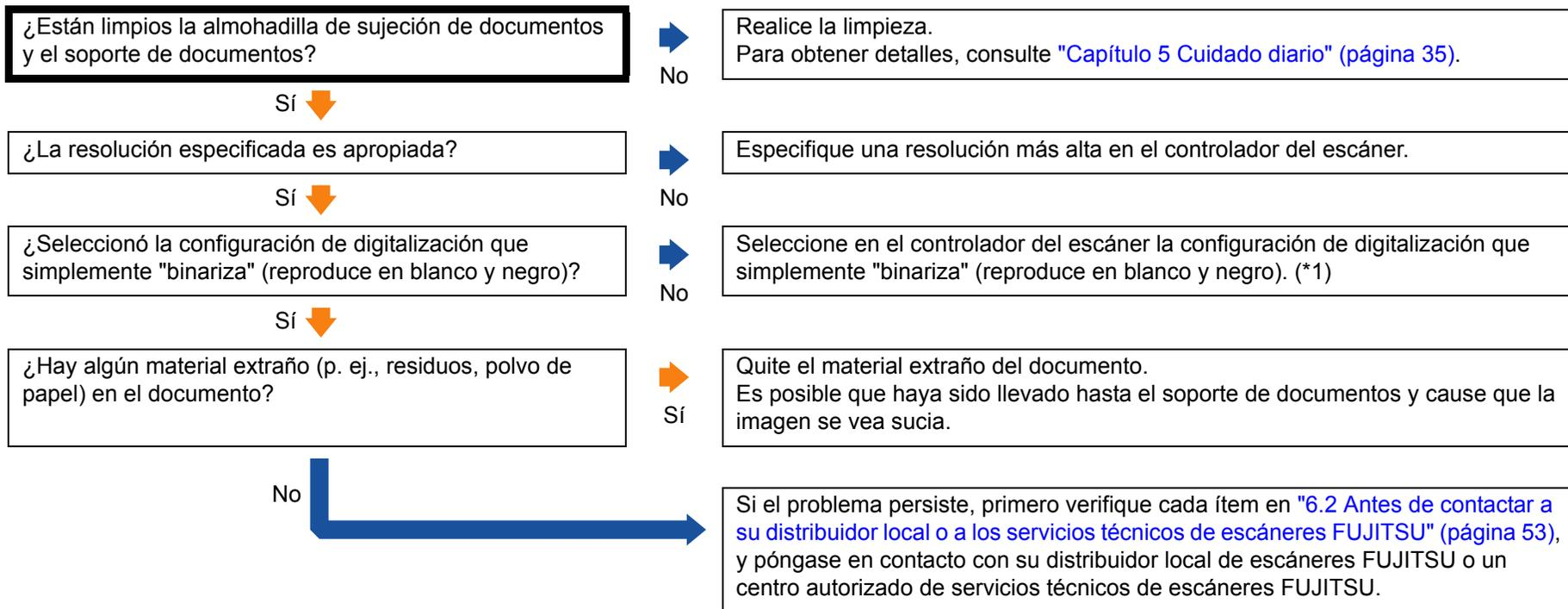
\*1: cuando digitaliza especificando escala de grises o color, la imagen digitalizada puede no ser nítida y clara. Si es posible, use el controlador del escáner para ajustar una configuración que simplemente "binariza" (reproduce en blanco y negro), luego realice una digitalización.
