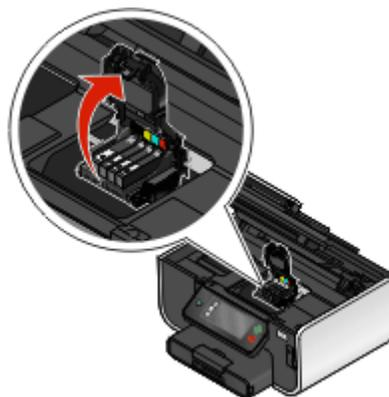
2 Extraiga el cabezal de impresión.
