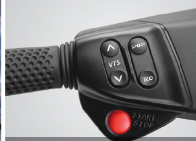
VTS™ (SISTEMA DE TRIM VARIABLE) ELÉCTRICO DE ALTO DESEMPEÑO
