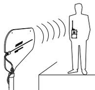
Esta antena unidireccional, de montaje remoto y banda ancha, proporciona una cobertura inalámbrica en un patrón de captación de cardioide. Se puede usar la PA805WB para asegurar una trayectoria visual de transmisión desde el transmisor al receptor cuando ésta no existe directamente hasta los transmisores. Además, ya que la antena PA805WB tiene cierta ganancia (debido a su característica direccional), es útil para cubrir distancias largas.
