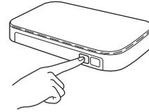
Esta función detectará automáticamente el modo (WPS o AOSS™) que utiliza el punto de acceso/enrutador inalámbrico para configurar el equipo.
