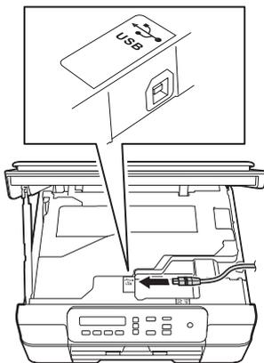
**c** Introduzca con cuidado el cable USB en el canal que lo dirige hacia la parte trasera del equipo. Conecte el cable al ordenador.
