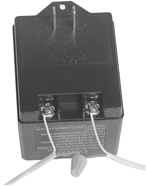
Fig. 50. Raccordement du transformateur.
