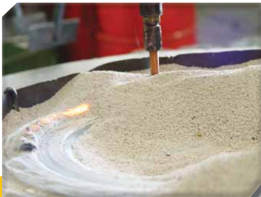
APORTACIÓN DEL RECUBRIMIENTO SOBRE UNA COMPUERTA
