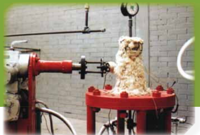
Medición de emisiones a alta temperatura, pruebas de ciclado de hasta 500 ciclos.
