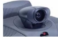
No instale una lente de conversión gran angular si el sistema utiliza el tipo de cámara que se muestra aquí.
