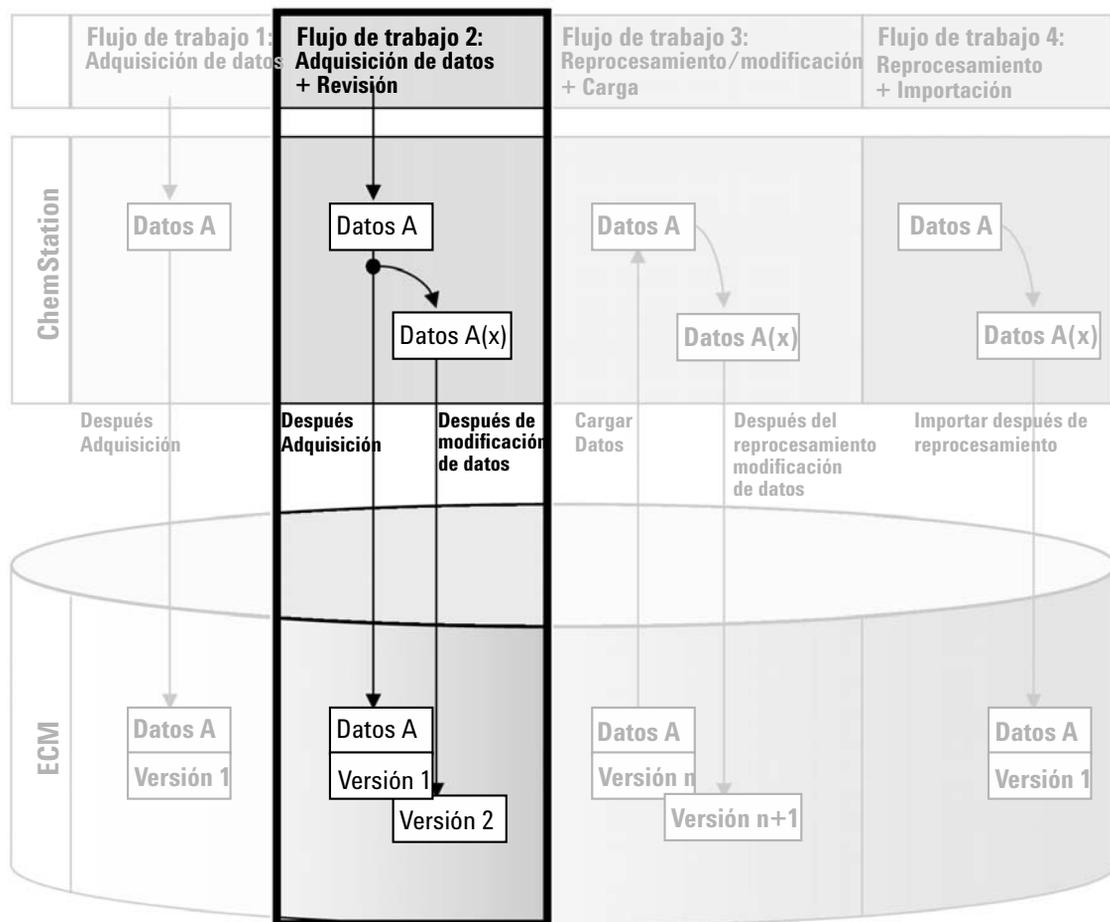
Figura 10 Revisión sin conexión durante una adquisición
