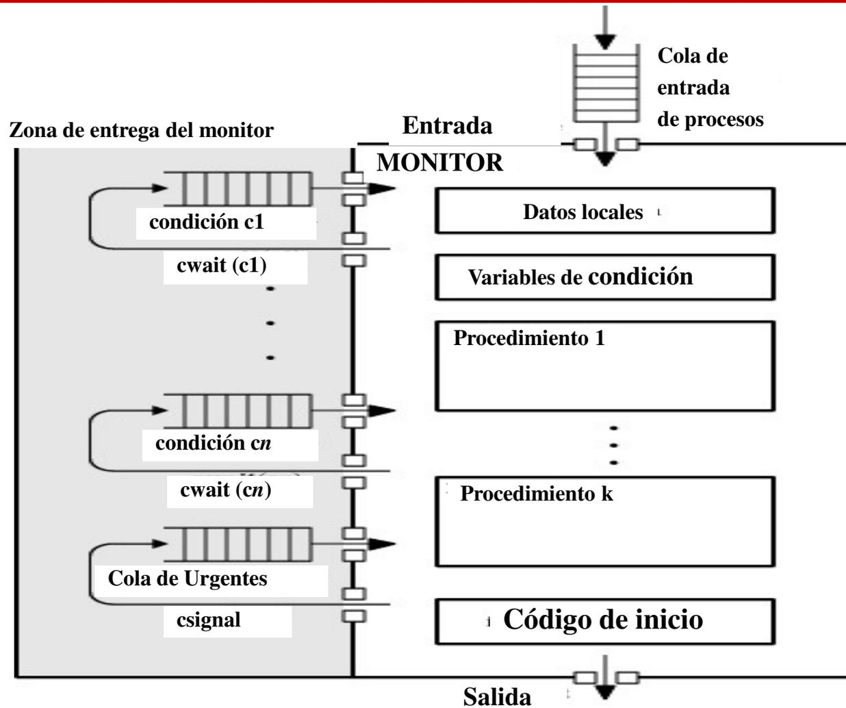
Figura 5.21. Estructura de un monitor.
