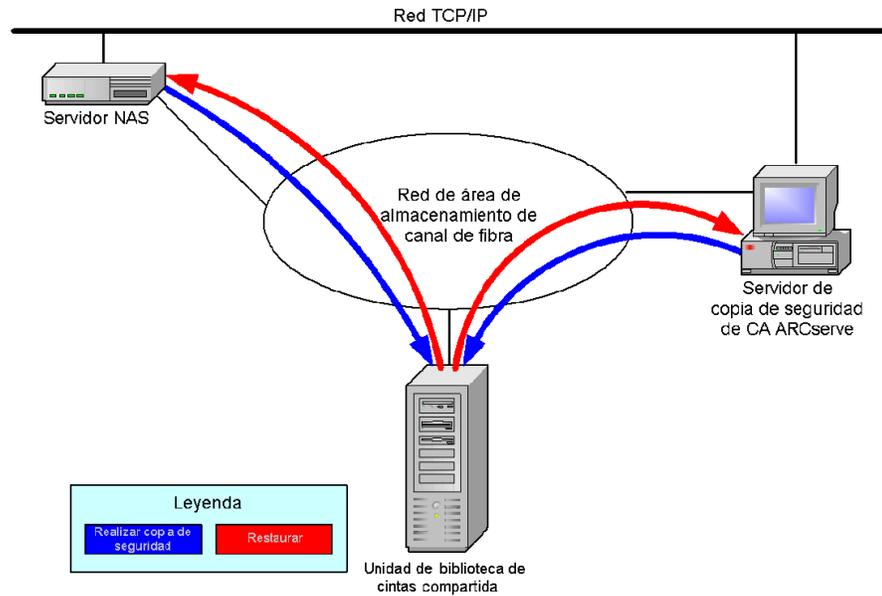
El siguiente diagrama muestra un ejemplo de dos o más servidores NAS conectados a la red SAN que comparten una unidad de cinta o TLU, y el servidor de CA ARCserve Backup no está conectado a la red SAN.
