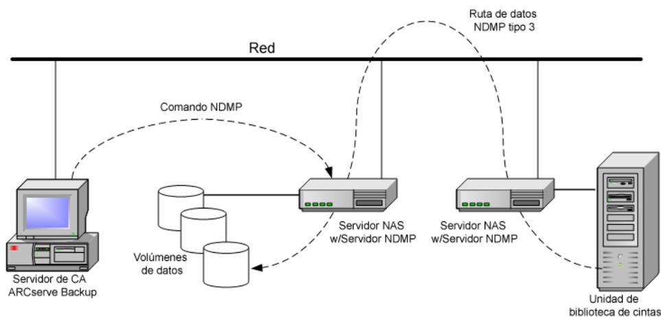
En el diagrama siguiente aparece un ejemplo de un archivador NAS en una restauración del servidor:
