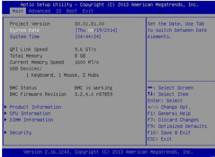
3. **Pulse la tecla F9 para cargar automáticamente los valores óptimos predeterminados.**
