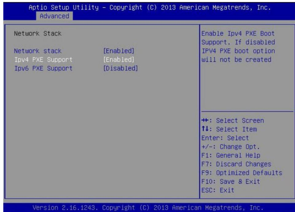
**d. Si es necesario, defina la compatibilidad con PXE adecuada (IPv4 o IPv6) en Enabled (Activado).**
