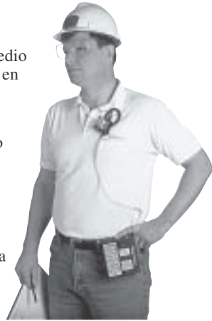
Sujete el portador al trabajador y la bomba al cinturón.
