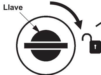
**Interruptor de encendido desbloqueado (encendido) FIG. 12-2C**
