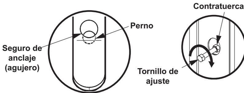
**Girar tornillo en sentido de la manecillas del reloj para alinear seguro de anclaje y perno FIG. 39-3**
