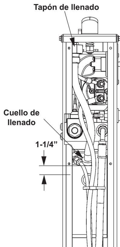
Inspeccionar nivel de fluido
