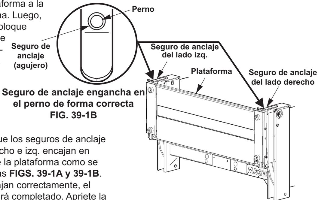
**Seguro de anclaje engancha en el perno de forma correcta FIG. 39-1B**
