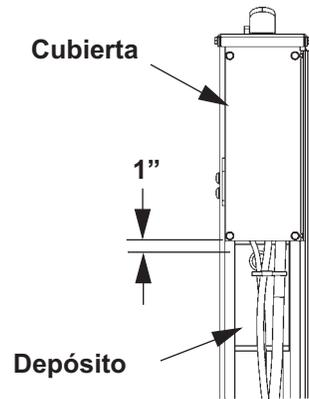
**Inspeccionar nivel de fluido
