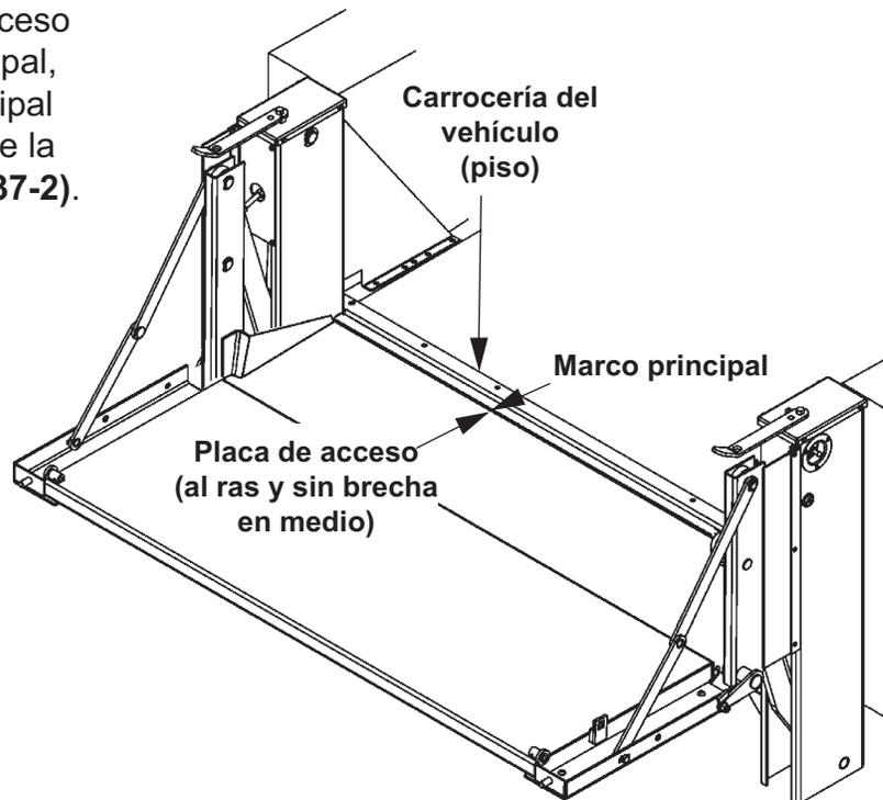
Inspeccionar placa de acceso
