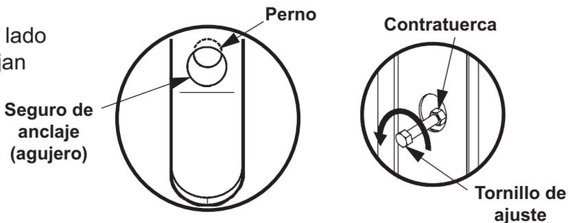
**Girar tornillo en sentido contrario/manecillas del reloj para alinear seguro de anclaje y perno FIG. 39-2**
