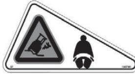
El vuelco de esta máquina puede causar lesiones graves o incluso mortales. No utilice la máquina cerca de o en una superficie inclinada, debido al riesgo de vuelco. Si la máquina está equipada con una estructura de protección antivuelco (ROPS), es necesario utilizar el cinturón de seguridad para prevenir lesiones graves o incluso mortales si el operador sale proyectado de la máquina.
