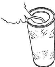
2. Mueva el chorro de aire subiendo y bajando por los pliegues hasta que deje de salir polvo. Procure no romper los pliegues del cartucho con la boquilla de aire.
