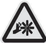
Ventilador rotatorio y correa. Puede causar graves lesiones. No operar con las guardas o las protecciones desmontadas. Pare la máquina antes de realizar el mantenimiento.
