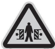
Zona de aplastamiento. Puede causar lesiones graves o incluso mortales. Coloque el pasador de bloqueo de articulación antes del mantenimiento.
