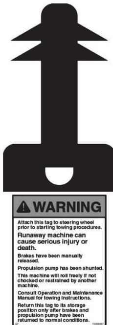
5. Coloque la etiqueta de advertencia en el volante de dirección.
