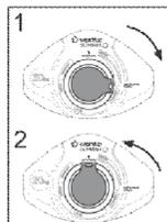
Para abrir la tapa y poner la ropa en el tambor, gire la perilla del temporizador hasta la posición "Destruir Tapa" (Figura 1) y enseguida gírela a la posición "APAGADO" (Figura 2). Al hacerlo, se escuchará un clic indicando que la tapa ha sido destrabada.
