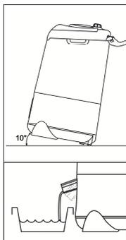
**EXCLUSIVO EASY MOVE SYSTEM** – Las ruedas en la parte inferior trasera de la Secarropas facilitan su movilidad, y no es necesario levantarla. Para utilizar este recurso, incline la Secarropas unos 10° y muévala utilizando el soporte enrollable, como indica la figura.
