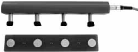
Fig 7.1: Sonda Wenner de cuatro puntos con placa de control y cable
