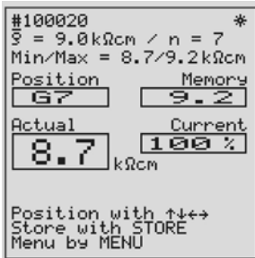
Fig. 7.2: Pantalla de medición de la resistividad
