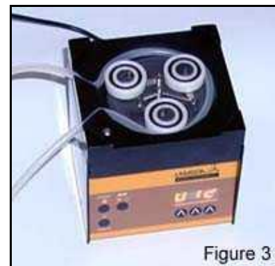
Fig. 3: Manguera / tubería en el cabezal
