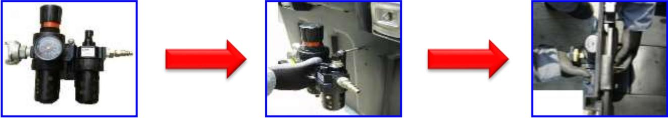
c) Antes de conectar el suministro de aire es necesario asegurarse de que la manguera está completamente estirada para evitar cualquier tipo de accidente al momento de operar el equipo.
