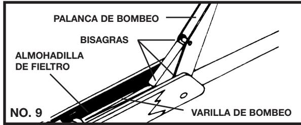
**¡CUIDADO!** Los lubricantes inadecuados como, por ejemplo, los lubricantes en aerosol, pueden incendiarse durante el bombeo. Use únicamente aceites para motores.
