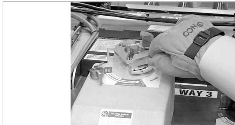
Figura 12. Girar el selector de operación para despejar el paso.
