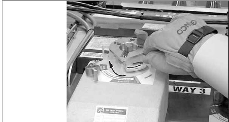
Figure 28. Gire el selector de operación para despejar el paso.
