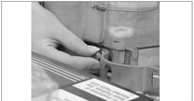
Figura 39. Volver a ajustar la tuerca y el perno.
