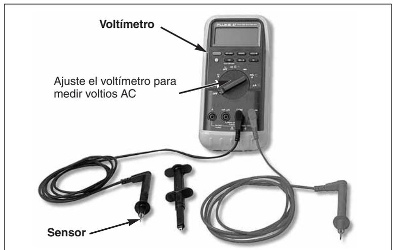
Figura 48. Voltímetro de alta impedancia y sensores de prueba.
