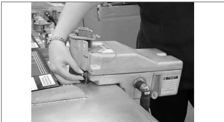
Figura 35. Aflojar la tuerca y el perno.
