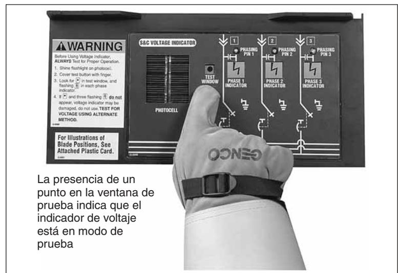
La presencia de un punto en la ventana de prueba indica que el indicador de voltaje está en modo de prueba
