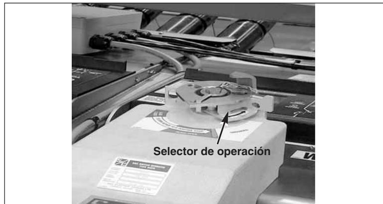
Figura 29. En la posición del extremo derecho, el selector de operación permitirá operaciones entre cerrado y abierto.
