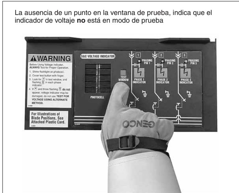
Figura 45. Asegurarse de que haya suficiente luz para activar el circuito de prueba y que el botón de prueba esté totalmente cubierto por un dedo enguantado.
