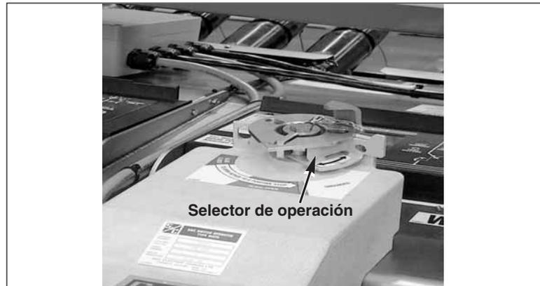
Figura 11. Selector de operación en la posición del extremo derecho.
