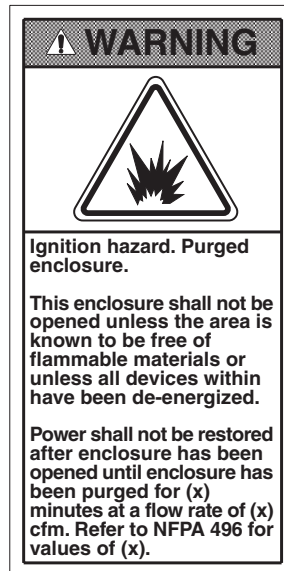
FIGURA 1-1 ETIQUETA DE ADVERTENCIA PARA GABINETES PURGADOS
