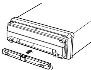
Alinee la ranura en la parte inferior del panel delantero con la guía en el cuerpo principal, y sujételo.
