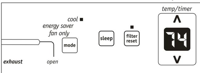
Nota: Esta función es un recordatorio para limpiar el filtro de aire (vea 'Cuidados y limpieza') para conseguir un rendimiento más eficiente. El LED (luz) se iluminará después de 250 horas de operación. Para reestablecer después de limpiar el filtro, oprima el botón "Filter Reset" y la luz se apagará.
