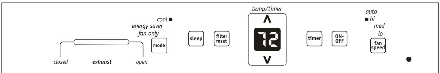
Este control de salida de aire permite al acondicionador reciclar el aire del interior de la habitación (CERRADO) o sacarlo al exterior (ABIERTO).
