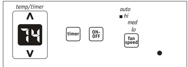
Nota: Pulse los botones de flecha arriba (▲) o abajo (▼) hasta que la pantalla muestre la temperatura deseada. Esta temperatura se mantendrá automáticamente entre 60° F (16° C) y 90° F (32° C). Si quiere que la pantalla muestre la temperatura actual de la habitación consulte la sección "Operar En Modo Sólo Ventilador" en la página 6.
