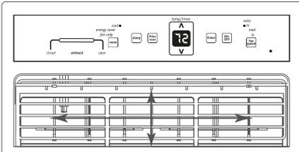
Las palas de direccionamiento del aire controlan la dirección del flujo de aire hacia arriba o abajo y hacia la derecha o la izquierda según sea necesario.
