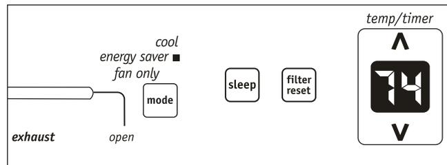
Nota: En este modo, el ventilador continuará a funcionar por 1 minuto después de que el compresor se apague. El ventilador después se enciende durante 20 segundos en intervalos de 10 minutos hasta que la temperatura esté por encima de la seleccionada, momento en el cual el compresor se volverá a encender.
