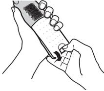
**2** Inserte la batería (1), y presiónela hasta que encaje en el compartimiento (2).
