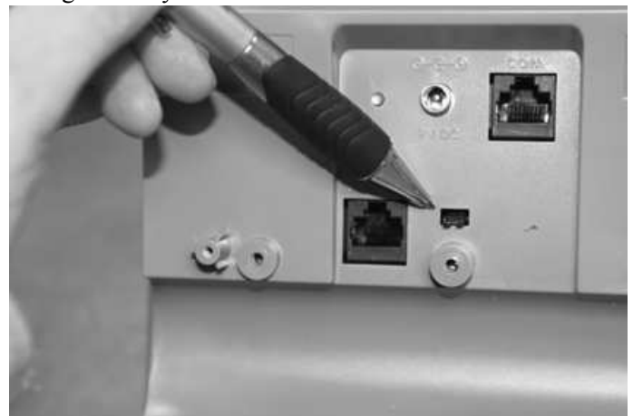
Remuevan el puente para tener acceso a los modos de configuración y calibración
