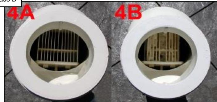
Si la celda se parece a 4A, vaya al paso C. Si la celda se parece a 4B, limpie la celda. (Consulte las páginas 19 a 21). Cuando la celda esté limpia, vaya al Paso C para reajustar.
