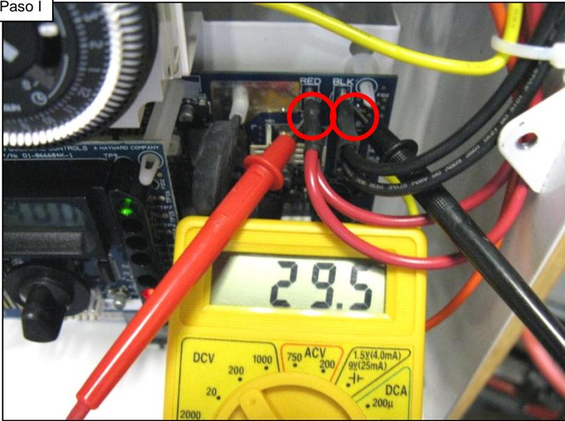
Si no hay voltaje o el voltaje es bajo, verifique que cada cable esté conectado según las instrucciones. Si la orientación de cables es correcta, vaya al paso K. Si el voltaje está bien, vaya al paso J.
