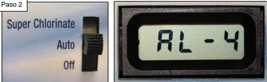
Cuando la unidad indica 'AL-4', mueva el interruptor hacia arriba a 'Super Chlorinate' y después de vuelta a 'Auto'.
