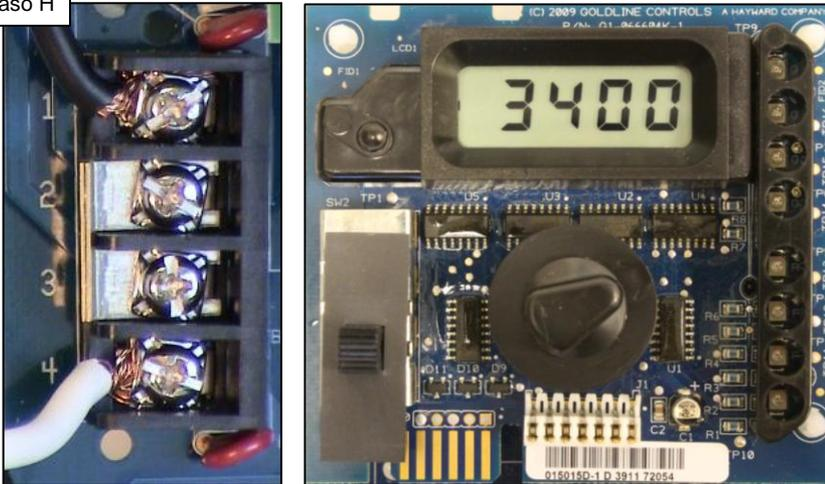
Si se trata de una nueva instalación o se ha reemplazado el tablero de circuitos, verifique que el tablero esté preparado para recibir el voltaje correcto. Los cables puente del terminal TB1 están configurados para 240 VCA (predeterminado en fábrica), pero hay 120 VCA aplicados en la caja de control.
