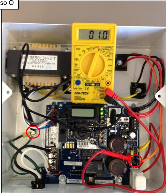
Si no hay voltaje o el voltaje es bajo, reemplace el tablero principal de circuitos (GLX-PCB-RITE). Si el voltaje es correcto, reemplace los rectificadores (GLX-DRK).
