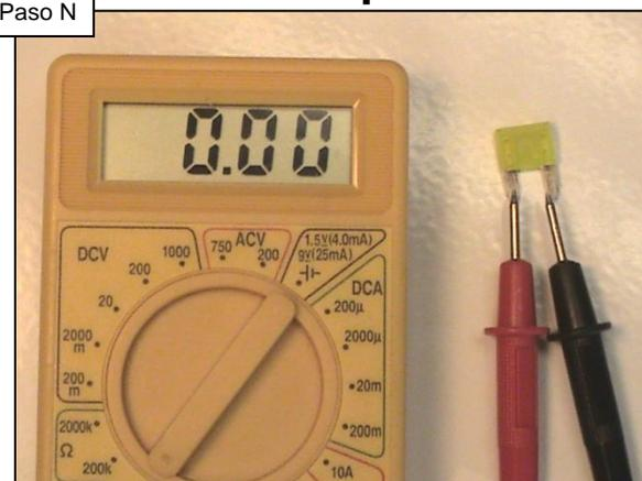
**Reemplace el fusible si está fundido.
