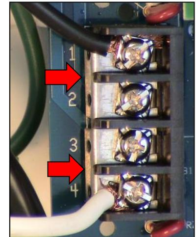
El ejemplo de arriba indica el cableado correcto de la unidad para 240 VCA; el ejemplo de abajo representa una configuración de cables para 120 VCA. Tome nota de la ubicación de los cables puente en cada diagrama. Si el cableado está BIEN, vaya al paso I.
