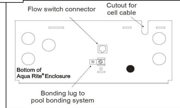
Verifique que la caja de control (donde se enchufa el interruptor de caudal) no esté corroída ni dañada. Si no hay daños en el tablero, reemplace el interruptor y repita la demora del filtro de 60 segundos después de la activación de la bomba; si después de 60 segundos no se apaga el LED de No hay caudal, reemplace el tablero.
