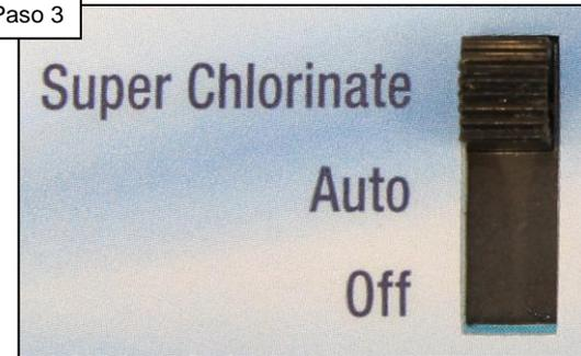
Para cambiar el tipo de celda, pase el interruptor a 'Super Chlorinate'
