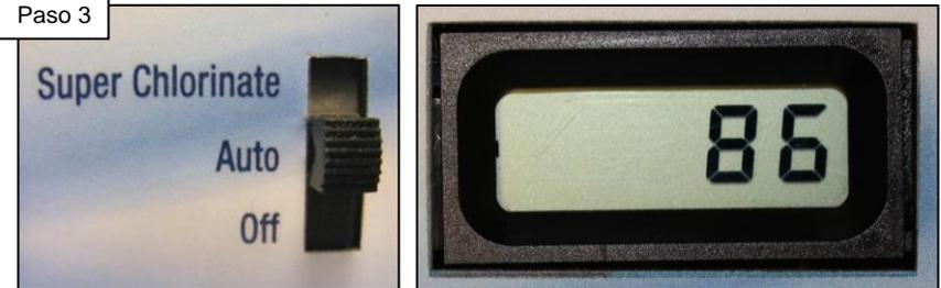
La lectura de la temperatura debe cambiar inmediatamente para indicar un valor en Fahrenheit. Si no es así, repita el paso 2.
