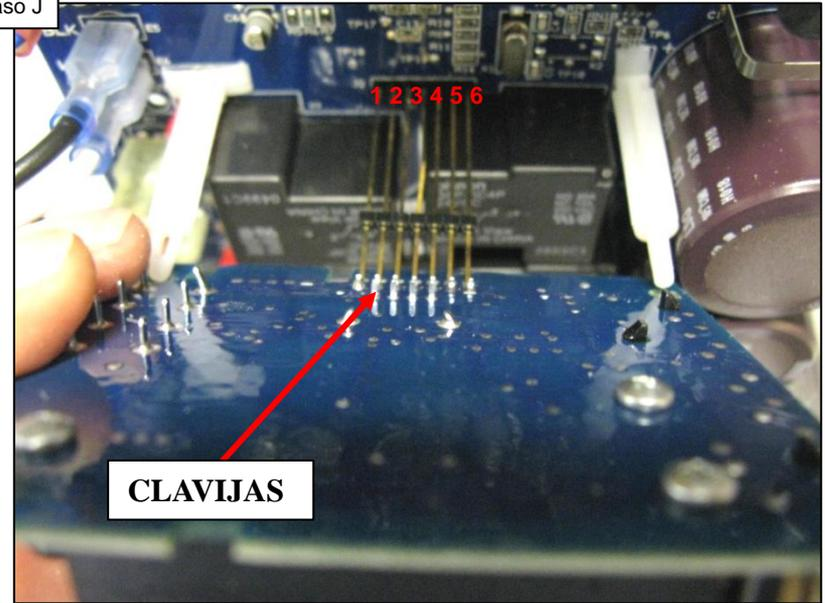
Quite o vuelva a asentar el tablero DSP. Es posible que las clavijas estén cortocircuitadas entre sí o que no hagan contacto con el conector. Si las clavijas están en buenas condiciones, compruebe que haya de 3 a 5 voltios (CC) en las clavijas 2 y 4, empezando por el lado izquierdo. Si el voltaje de CC es correcto, reemplace el tablero DSP (GLX-PCB-DSP).
