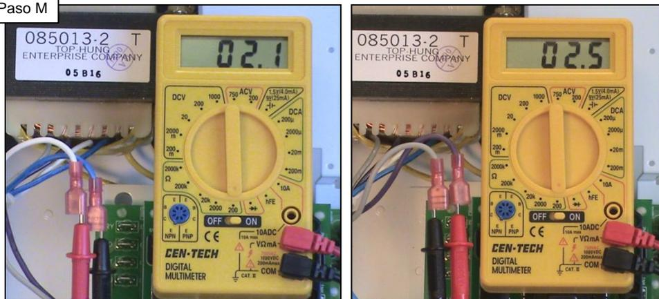
**Introduzca las sondas y mida la resistencia entre los cables azul y blanco y los cables violeta y gris. Las lecturas deben ser de 2.0 a 2.9 ohmios.**
