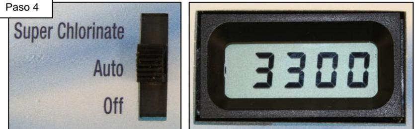
Cuando desaparezca el signo negativo, este número indicará la nueva lectura de la concentración promedio de sal. Si este valor no tiene una tolerancia de 500 ppm con respecto a la prueba independiente, reemplace la celda. Si este número indica una tolerancia de 500 ppm con respecto a la prueba independiente y destella el LED de Inspeccionar celda, agregue sal hasta que la concentración sea mayor que 2700 ppm.
