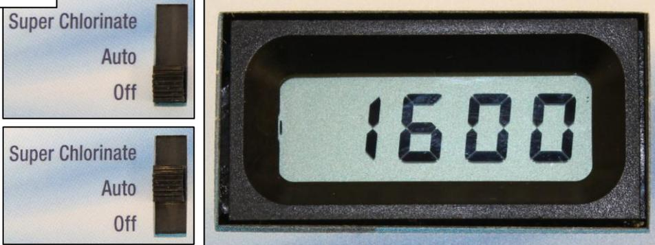
Para reajustar, mueva el interruptor a 'Off' (Apagado), y después de nuevo a 'Auto'. Espere a que el relé haga clic (en 5 a 10 segundos).
