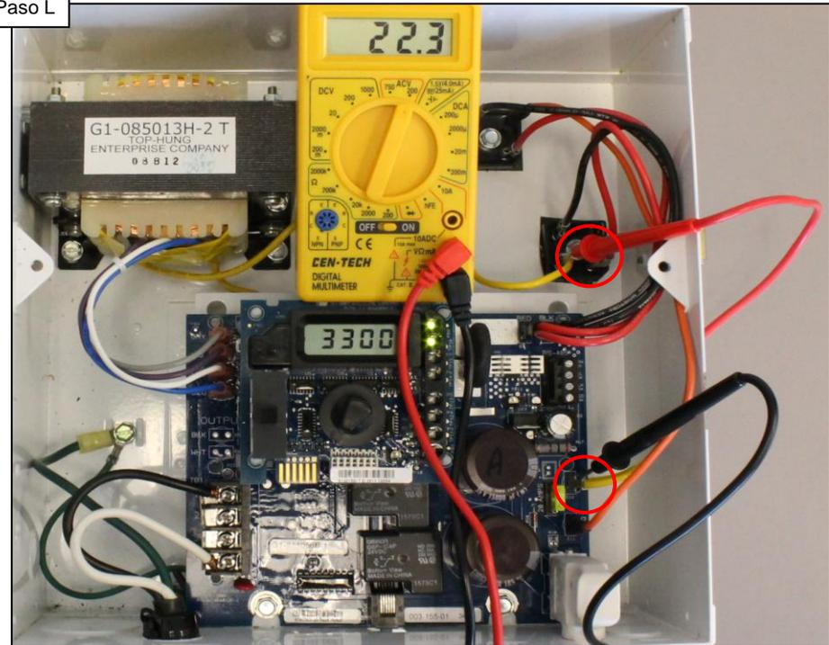
Si el voltaje es correcto, vaya al paso N. Si no hay voltaje o el voltaje es bajo, vaya al paso M.
