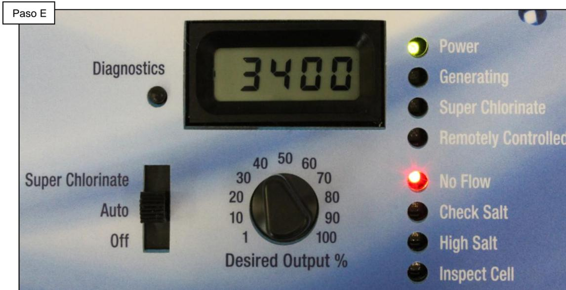
**Si destella el LED de No hay caudal, asegúrese de que la bomba esté cebada y haga fluir una cantidad adecuada de agua por el elemento del interruptor de caudal durante un mínimo de 60 segundos (el caudal requerido es de 11 gpm). Si después de 60 segundos el LED no se apaga, vaya al paso F.**
