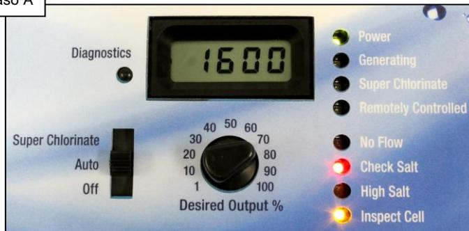
Pruebe la concentración de sal en la piscina usando un método de prueba independiente. Si la concentración de sal está entre 2700 y 3400 ppm, vaya al paso B. Si la concentración de sal está por debajo de la gama recomendada, agregue suficiente sal para lograr una concentración de sal de 3200 ppm. (Consulte el Cuadro de sal, Página 27).
