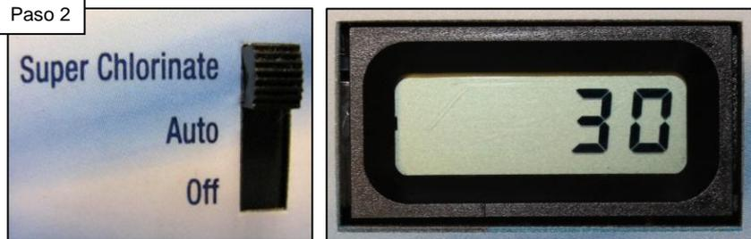
Una vez mostrada la temperatura en grados centígrados, mueva el interruptor hacia arriba a 'Super Chlorinate' (Superclorar) y después de vuelta a 'Auto'.
