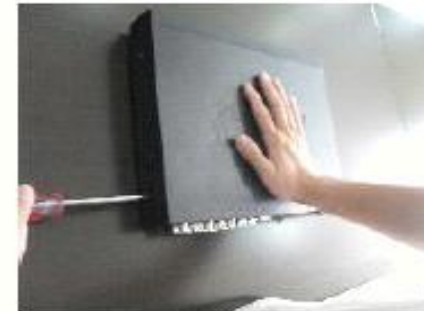
6) Coloque los tornillos en ambos lados de la cubierta de la DVR
