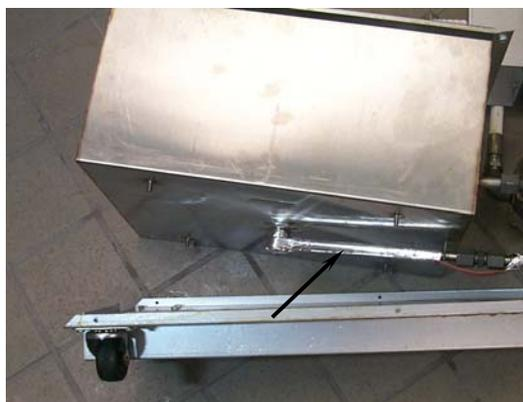
Retire la cinta aisladora de lámina de aluminio para dejar expuesta la tira del calentador (flecha).
