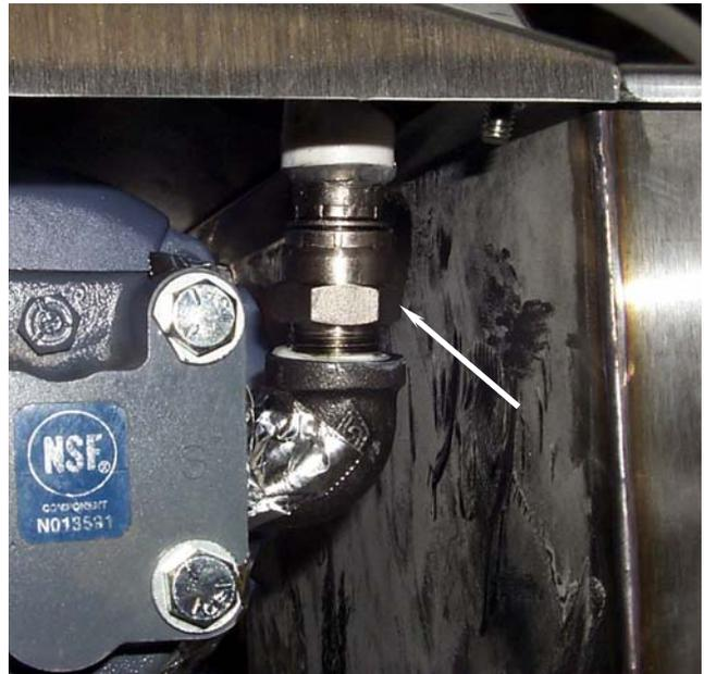
Retire el conector de manguera (flecha) con una llave de extremo abierto. Use sellador de tuberías al instalar la nueva manguera.
