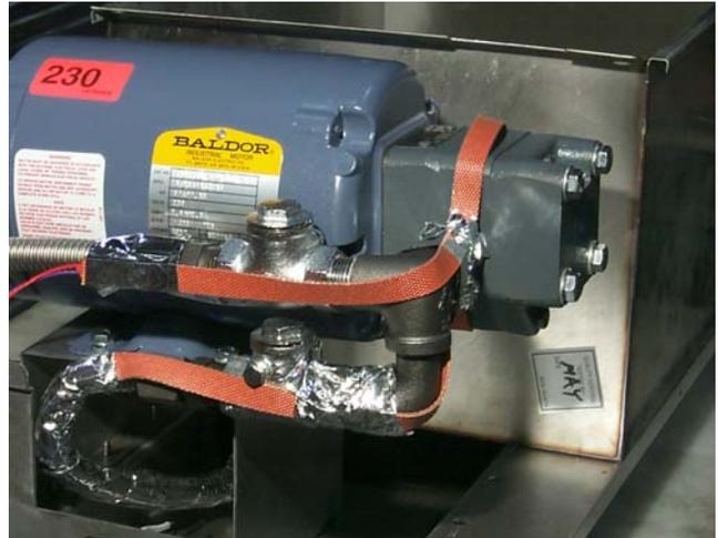
Tendido de la tira del calentador en líneas flexibles y bomba [230V PF50 (Retorno/Succión)].
