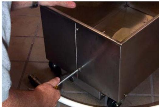
Retire los tornillos que sujetan los paneles exteriores.
