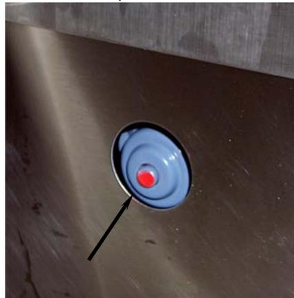
El interruptor de sobrecarga térmica del motor (flecha) se sitúa en el lado izquierdo del filtro.
