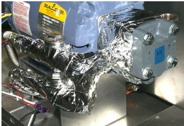
Retire la cinta aisladora de lámina de aluminio que cubre la tira del calentador y retire la tira del calentador de la bomba y las líneas flexibles. Desconecte las líneas flexibles de las conexiones de la válvula de retención.
