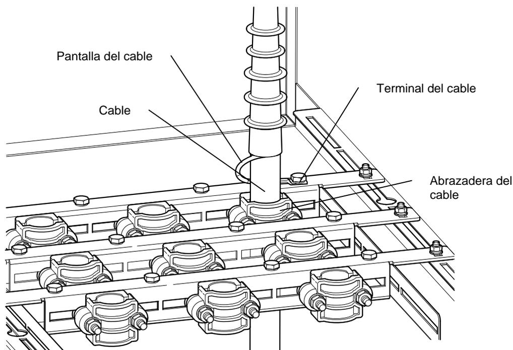
Figura 4.47 AMC6: Conexión de cables para 3 cables de salida
