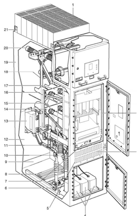
**Figura 3.10:** Elementos principales de la celda AMC-S
