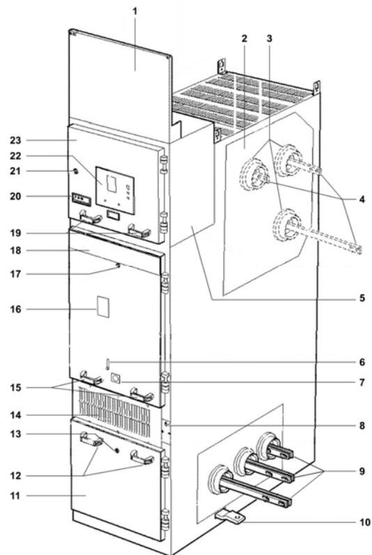
**Figura 3.8:** Elementos principales de la celda AMC-M1/HG
