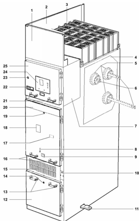
**Figura 3.9:** Elementos principales de la celda AMC-S
