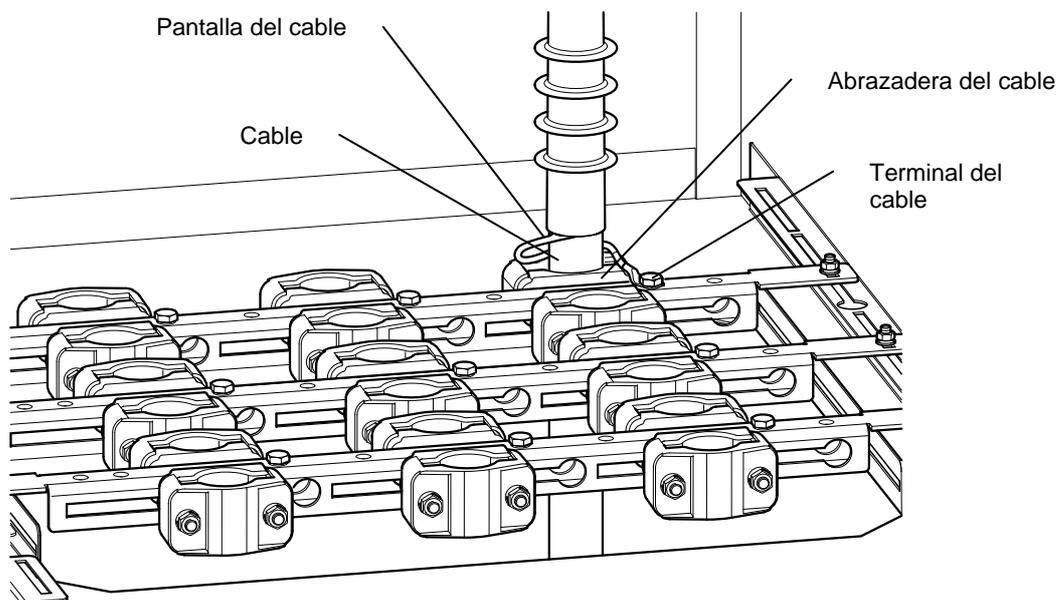
**Figura 4.38 AMC9:** *Conexión de cables para 4, 5 y 6 cables de salida*
