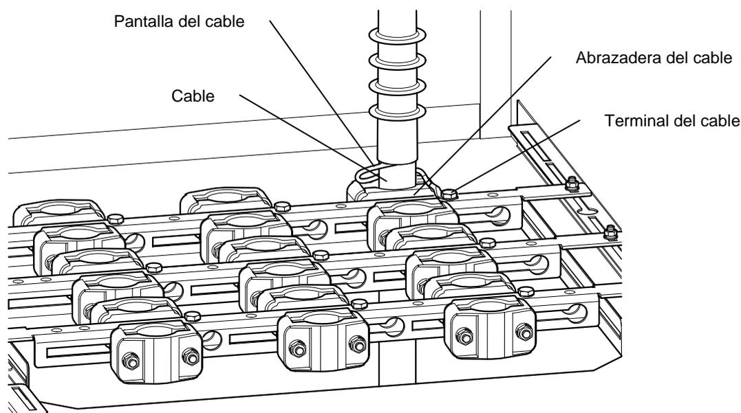
**Figura 4.21 AMC9:** *Conexión de cables para 4, 5 y 6 cables de salida*
