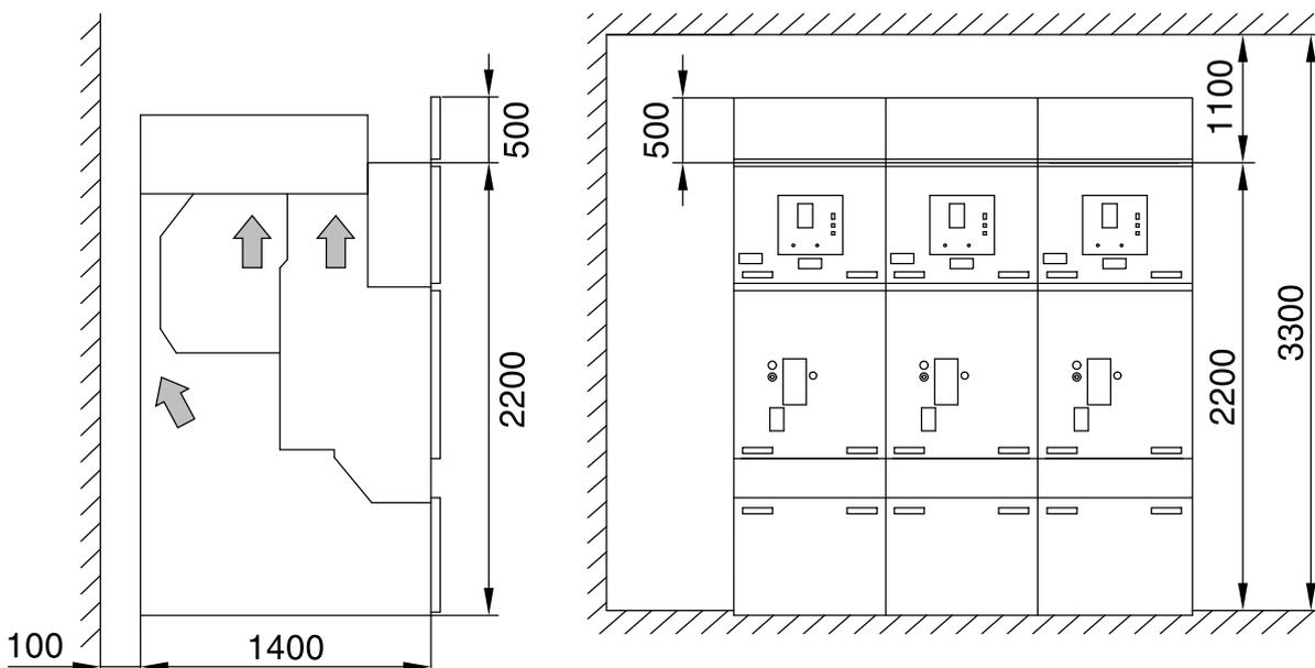
Figura 5.22 AMC con absorbedores de arco
