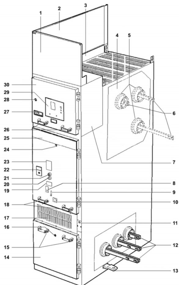
Figura 3.4: Elementos principales de la celda AMC-LG
