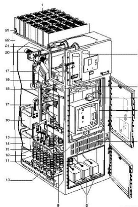
**Figura 3.3:** Elementos principales de la celda AMC9-L
