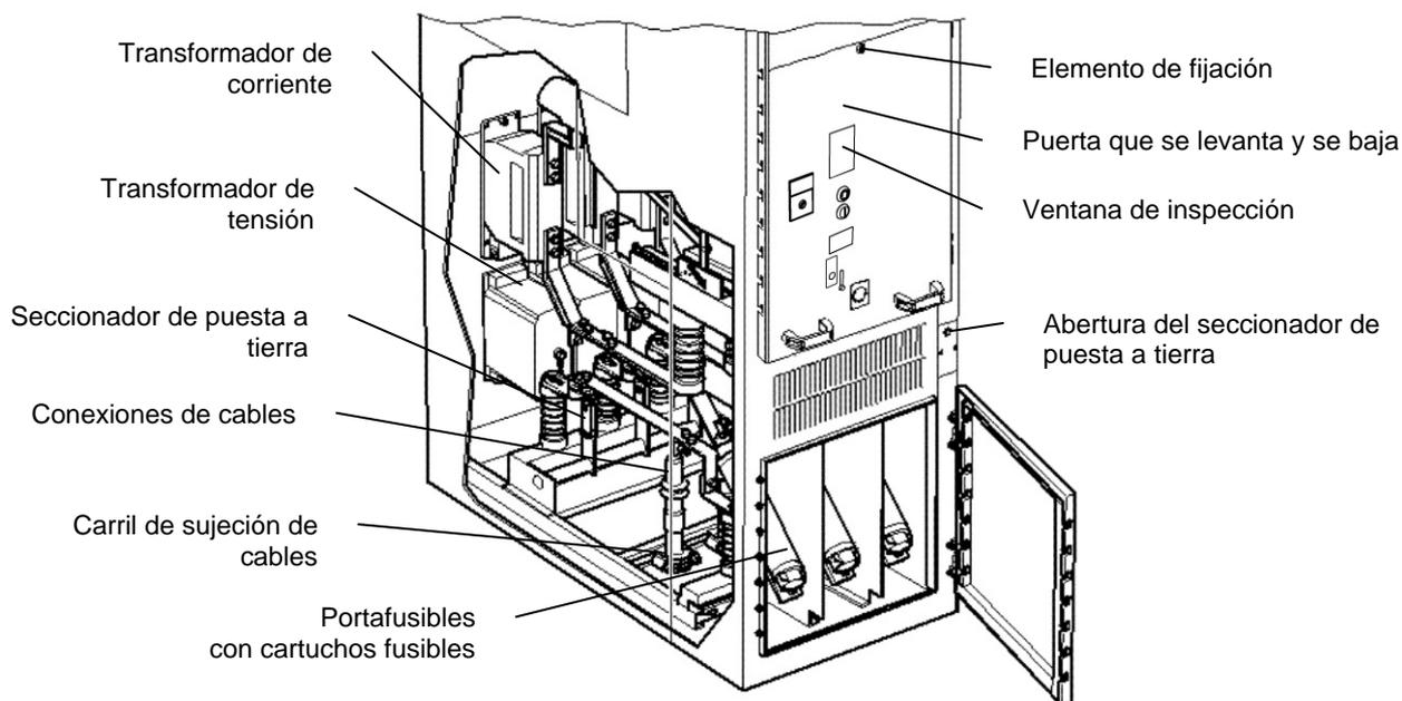
**Figura 5.17 Celda AMC con portafusibles**
