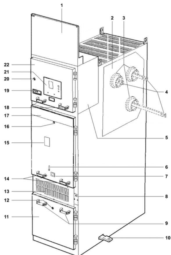
**Figura 3.7:** Elementos principales de la celda AMC-M5/H
