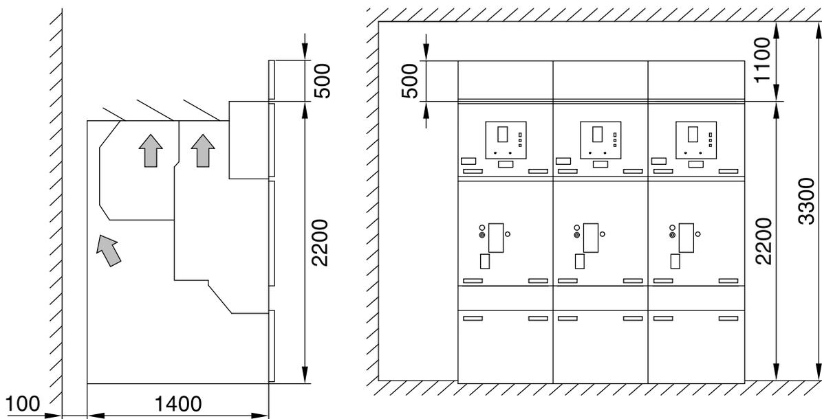
Figura 5.21 AMC con trampillas de regulación de presión
