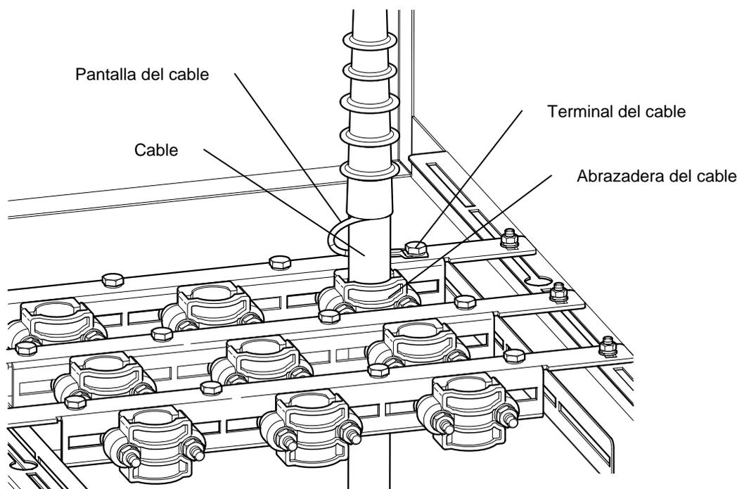
Figura 4.37 AMC6: Conexión de cables para 3 cables de salida
