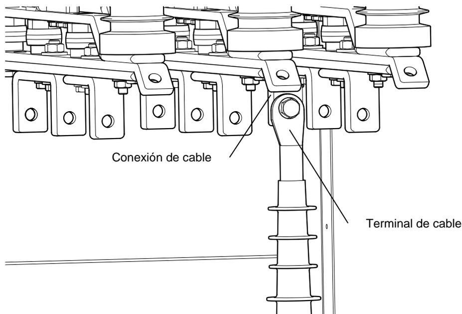
Figura 4.35 AMC6: Conexión de cables para 3 cables de salida
