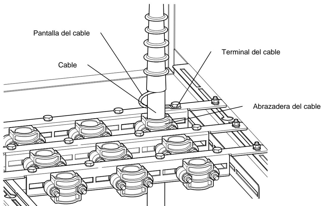
Figura 4.20 AMC6: Conexión de cables para 3 cables de salida
