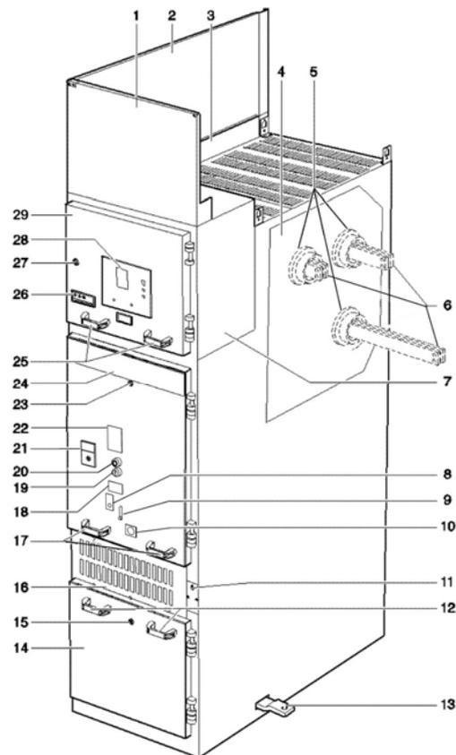
**Figura 3.5:** Elementos principales de la celda AMC-T
