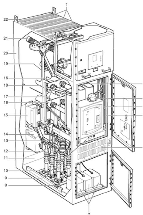
**Figura 3.2:** Elementos principales de la celda AMC6-L
