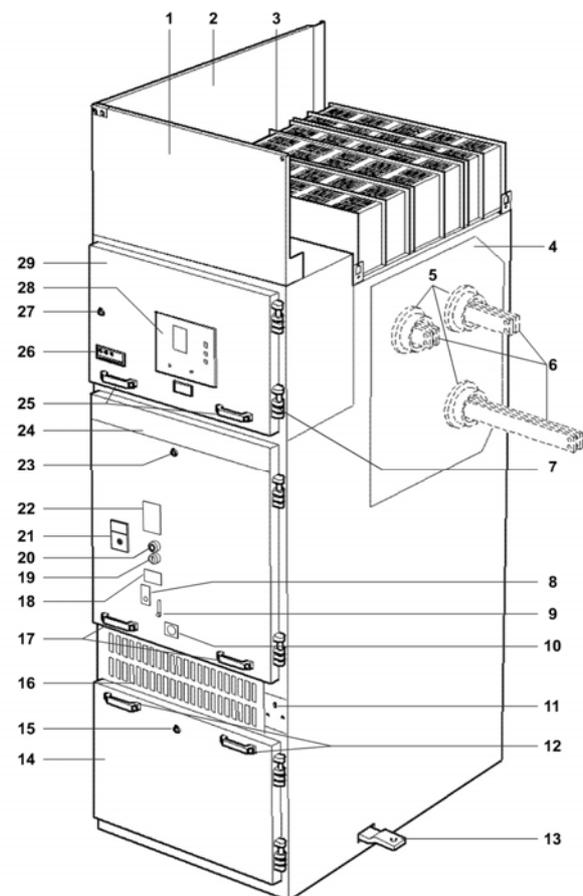
Figura 3 1: Elementos principales de la celda AMC-L
