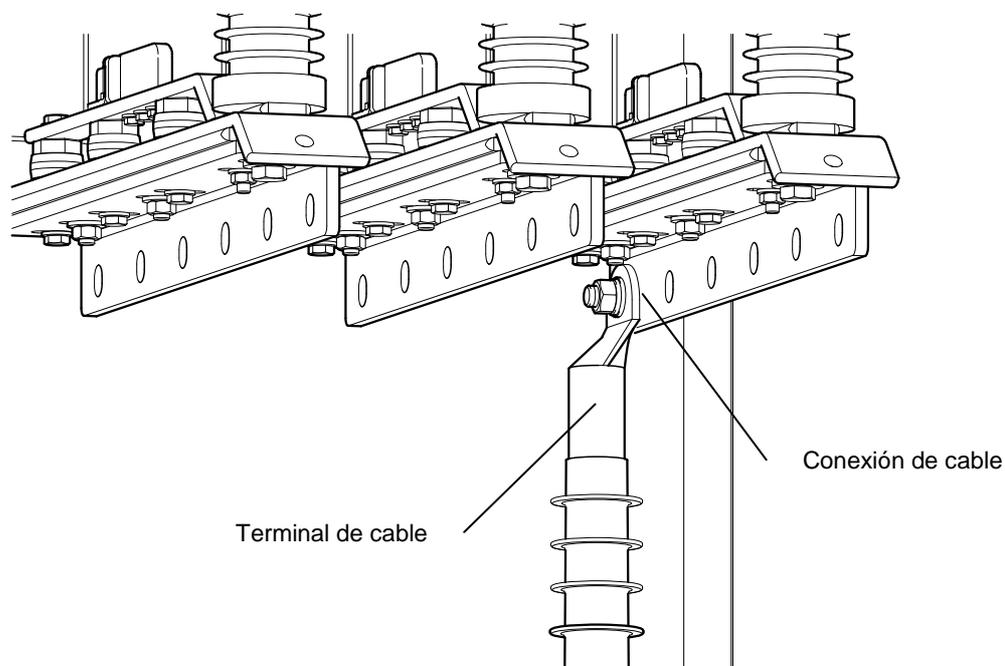
Figura 4.36 AMC9: Conexión de cables para 4, 5 y 6 cables de salida
