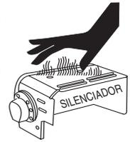
■ **SIEMPRE** permita que el motor se enfríe antes de agregar combustible ó realizar el servicio ó mantenimiento. El contacto con componentes calientes puede causar serias quemaduras.
