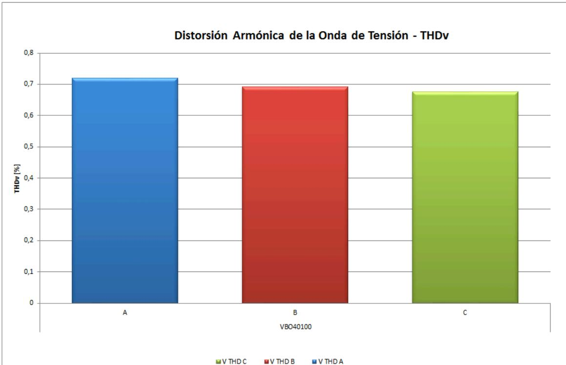
**Figura 33 Distorsión Armónica Total en Barras 115 kV**
