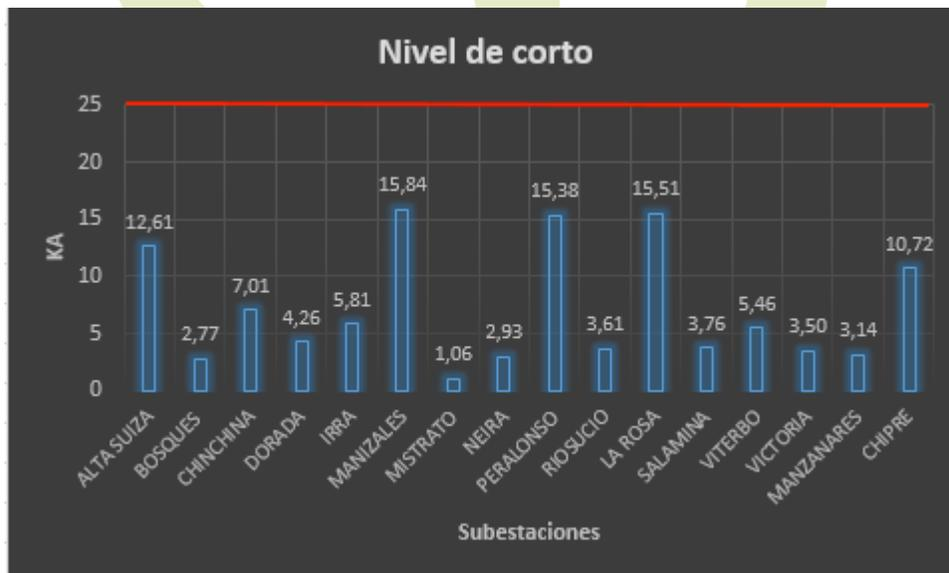
Figura 38 Nivel de corto en subestaciones con 25 KA de capacidad nominal
