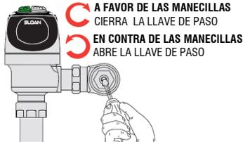
**E** Active el Fluxómetro colocando la mano frente a la Lente del Sensor de Sloan ECOS® Electrónico por diez (10) segundos (u oprima el botón de sobrepasso) y retírela.
