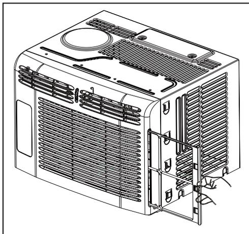
Limpie de tanto en tanto su aparato de aire acondicionado de forma que se mantenga como nuevo. **Asegúrese de desconectar el equipo de la corriente antes de limpiarlo para evitar incendios y choques eléctricos.**
