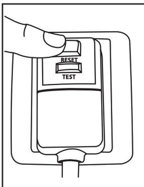
El cable de corriente contiene un dispositivo cortacorriente que detecta daños en el cable. Para comprobar su cable de corriente haga lo siguiente:
