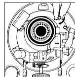
11. Gire la perilla del regulador de la mecha para asegurarse de que la mecha se mueva suavemente hacia arriba y hacia abajo.
