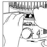
4. Asegúrese de que la cámara de calor esté debidamente asentada moviendo la manilla de la cámara de calor hacia la izquierda y la derecha.
