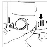
3. ENCENDIDO CON FÓSFOROS Usted no tiene por qué encender la estufa con fósforos, pero si ello fuera necesario, abra la puerta de acceso, levante la cámara de calor y con el fósforo toque la parte superior de la mecha. No deje caer partes quemadas del fósforo sobre la mecha ni deje que permanezcan ahí.
