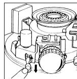
12. Vuelva a colocar la cámara de calor interior en la Parte superior del tubo de aire primario.
