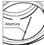
7. Pliegue la mecha nueva en cuatro e insértela en el regulador de la mecha desde la parte de abajo del regulador de la mecha. Coloque uno de los pasadores en una de las aberturas alineadas. Si tiene dificultades para hacer esto, gire suavemente la perilla de ajuste de la mecha en el sentido de las agujas del reloj. Luego inserte los otros dos pasadores girando la perilla de ajuste de la mecha si fuera necesario.
