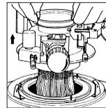
5. Pase dos dedos entre la banda de color naranja de la mecha y el regulador de la mecha. Después de levantar los tres (3) pasadores de sus ranuras, pliegue la mecha y sáquela.
