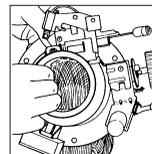
9. Baje el regulador de la mecha hacia el depósito de combustible, guiando la parte posterior de la mecha, de modo que encaje en el tubo de aire primario y quede puesta de manera pareja en su lugar.
