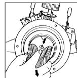
6. Coloque el regulador de la mecha a un lado. Luego, alinee las dos (2) aberturas del regulador de la mecha: 1) las ranuras diagonales de la parte fija del regulador de la mecha y 2) las ranuras de las partes móviles del regulador de la mecha controlado por la perilla del regulador de la mecha.
