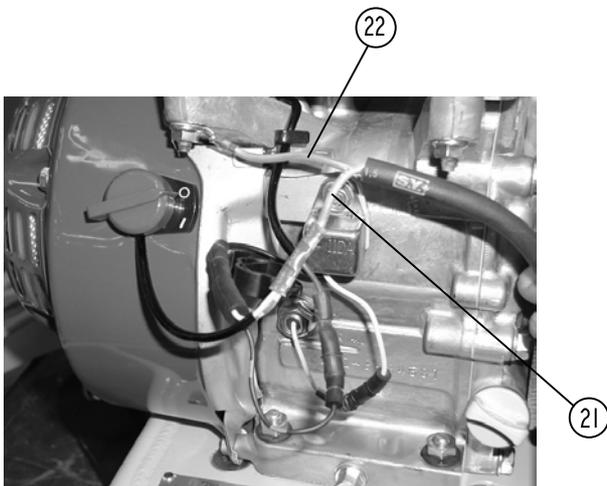
Conecte el cable 21 al cable de parada del motor y conecte el cable 22 a la carcasa del motor.
