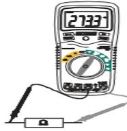
1. Fije el selector de funciones en la posición verde de la escala de  $\Omega$ .
