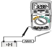
1. Inserte el conector tipo banana del cable negro de prueba en el conector COM.
