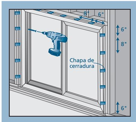
4. En cada calza y sólo a través de la primera pared interior de la jamba, taladre un orificio de paso de 3/8". Luego, taladre un orificio guía de 1/8" a través de la pared con jambas, la calza y el marco.
