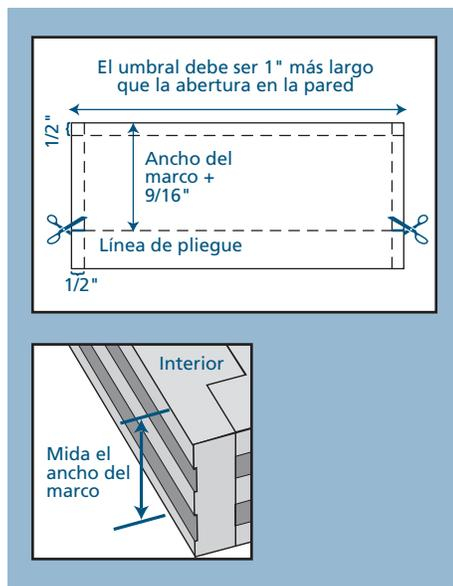
6. Para la losa continua, corte a lo largo de la línea de pliegue.
