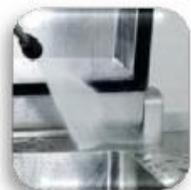
Cuando limpie el equipo, la clavija nunca debe estar inmersa o rociada con agua; séquela después de la limpieza. Puede limpiar el equipo a los lados o por encima con la manguera a presión, pero nunca por debajo.
