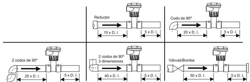
El sensor debe colocarse en un interceptor o en un sitio de flujo ascendente, para que así pueda estar protegido contra la exposición a burbujas de aire cuando el sistema esté funcionando.
