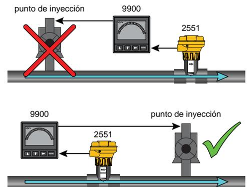
Seleccione una posición con suficiente distancia de tubo recto inmediatamente aguas arriba del sensor.
